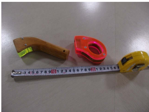
洗濯機用(左)とガスの元栓用(右) ツマミ回し
