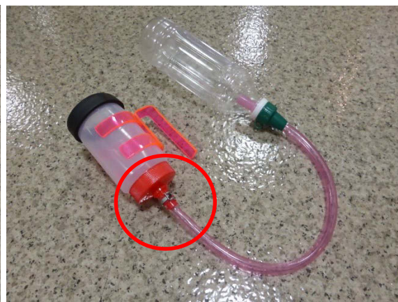
漏れ防止用の止め金具の様子
