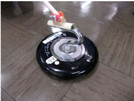
ジェットローラーを押さえるスティック先端
