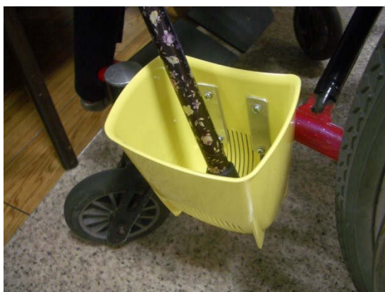
杖立て取付け後の状況
