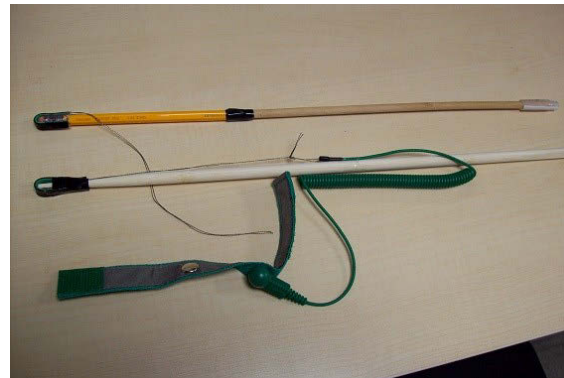
先端に導電ゴムシートを付けた二次試作品
