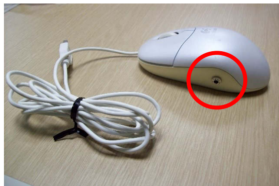
改造後の外観(マウス左側に外部端子)
