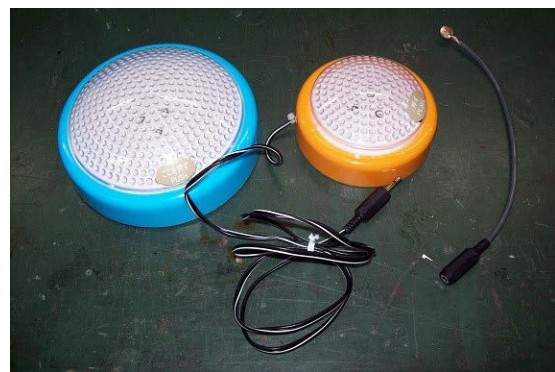
改造してスイッチへ転用した LED ライト 2 個と BD アダプタ(右端)
