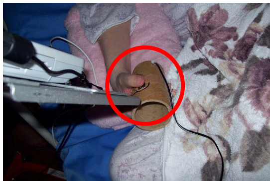
紙筒へタクトスイッチを埋め込み
