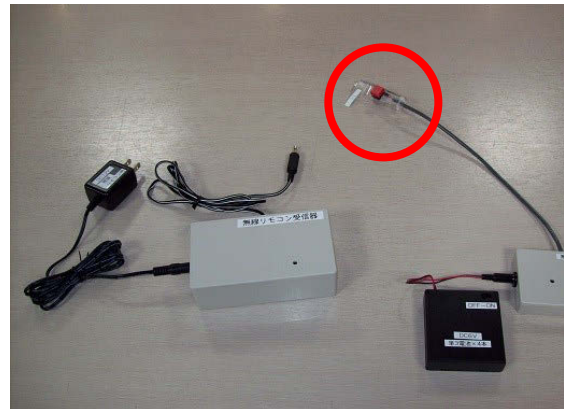
製作した無線式の呼出装置(送受信器)
