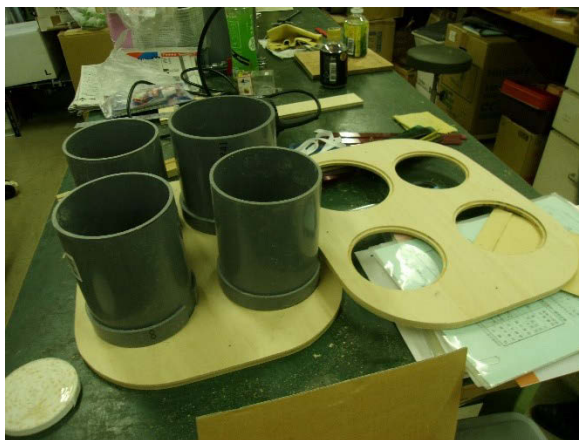
ベニヤ板に塩ビパイプを載せて製作
