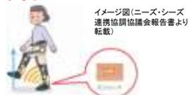
・高齢者等の外出をサポートし、転倒予防や歩行等を補助するロボット技術を用いた装着型の移動支援機器
