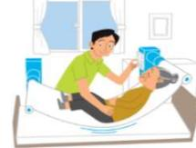
・ロボット技術を用いて介助者による抱え上げ動作のパワーアシストを行う非装着型の機器
